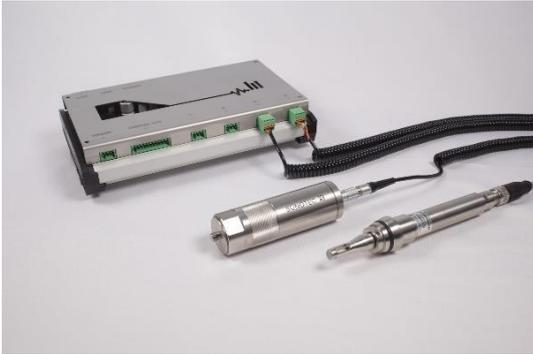
An der IMMS GmbH entwickelte sUSE-Hardware-Plattform für das Druckluftmonitoring mit Ultraschallsensor von SONOTEC (links) und Volumenstromsensor von Postberg (rechts).
